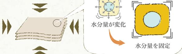
②単板の木材細胞にフェノール樹脂※を含浸。個々の細胞を固めることで、木材の寸法変化の原因である、水分の増減を抑制します。
