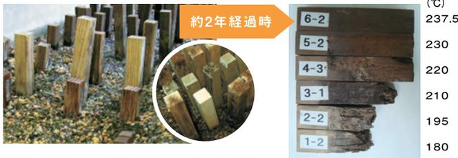
腐朽が起こりやすい高温多湿の室内で土中に処理材を埋めます。野外の土中に埋めた場合と比べてみると、2~4倍の速さで腐朽が進むと言われています。
